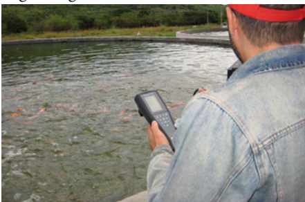
Comprobación manual de un estanque con el YSI Professional Plus.
