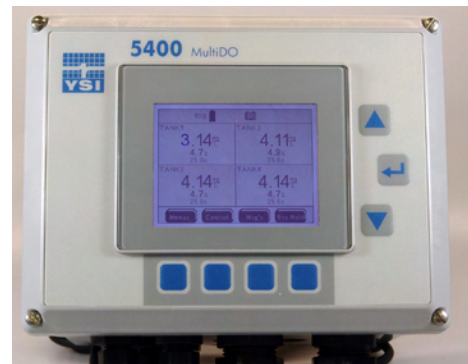
YSI 5400 instrumento para Oxígeno Disuelto multiple con posibilidad de alarmas y controles.
